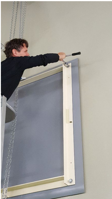
Fig 1. Einbau des Prüflings. Dichtung durch Rahmen.
