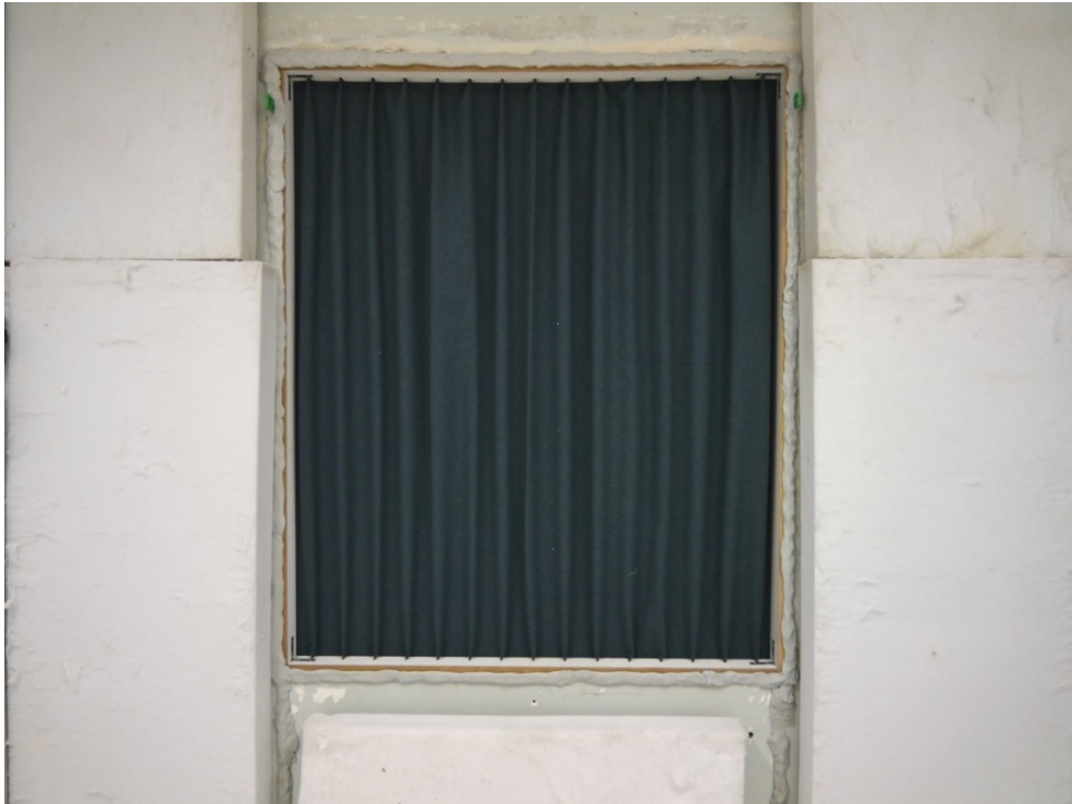
Abbildung B.1. Exemplarische Abbildung eines Prüflings im Fensterprüfstand (empfangsraumseitig).
