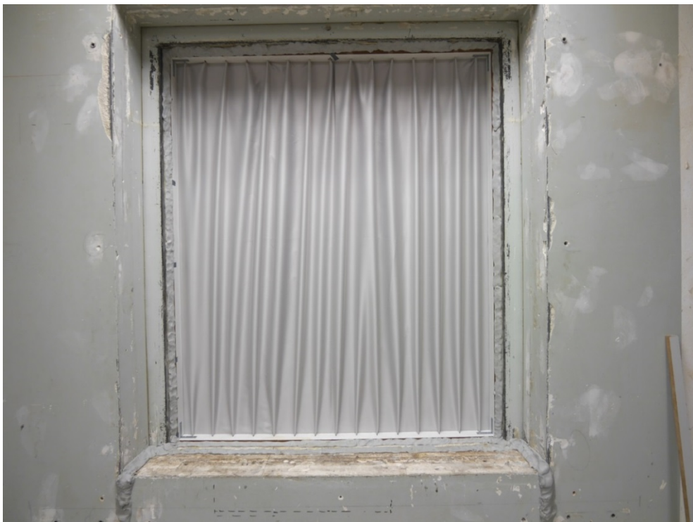
Abbildung B.2. Exemplarische Abbildung eines Prüflings im Fensterprüfstand (senderraumseitig).
