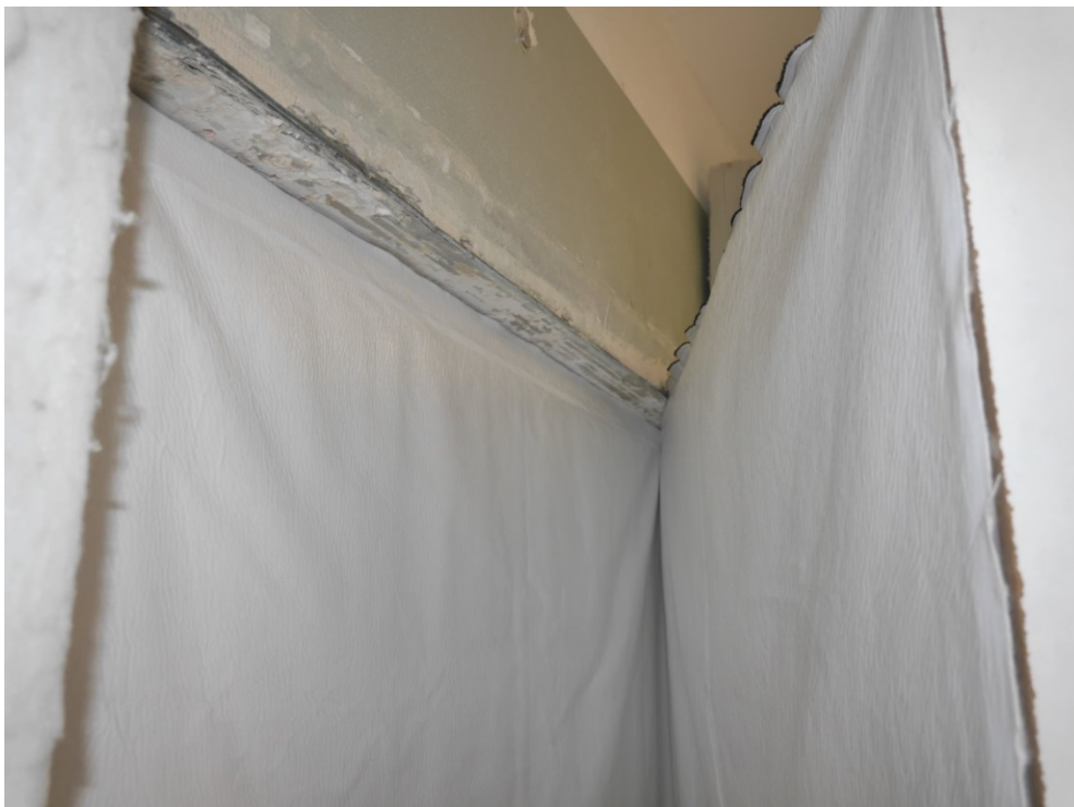
Abbildung B.4. Exemplarische Abbildung eines Aufbaus mit zwei Lagen Molton/Folie im Fensterprüfstand (Prüfaufbau geöffnet).
