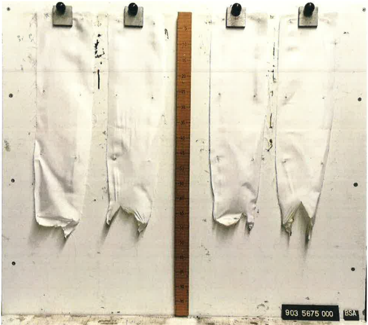
Abb. 4: Aussehen der 4 Proben nach Brandschachtversuch B
