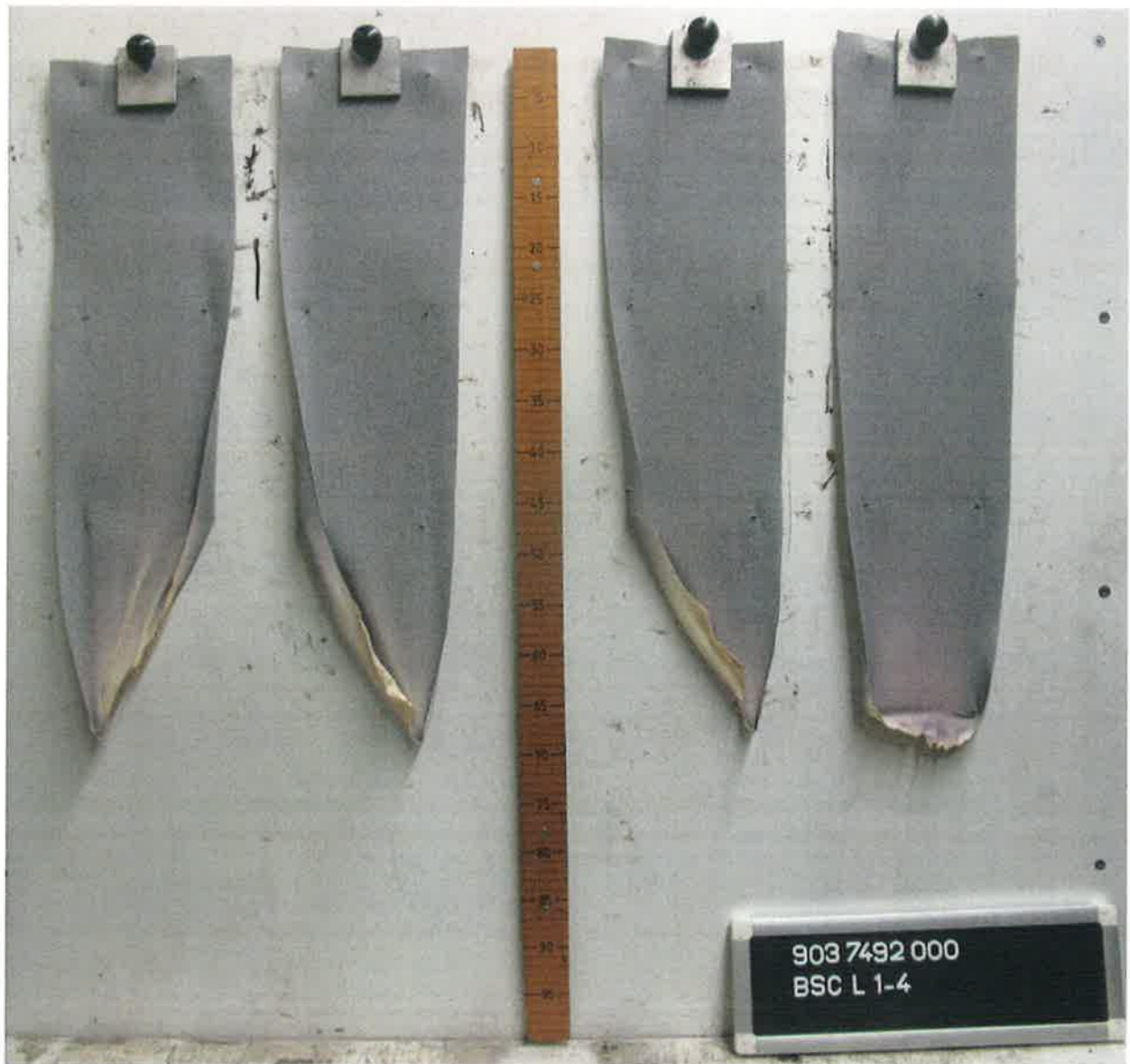
Abb. 4: Aussehen der 4 Proben nach Brandschachtversuch A
